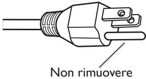
Questa apparecchiatura è dotata di una spina con messa a terra a tre poli. Non rimuovere il polo di terra. Per motivi di sicurezza, questa spina può essere utilizzata solo con una presa di corrente dotata di messa a terra. Se non è possibile inserire la spina nella presa, rivolgersi a un elettricista.
